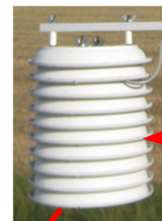
Abri pour le sht15 : thermomètre et hygromètre
