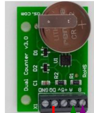
DS2438 : double compteur (anémomètre et pluviomètre)
